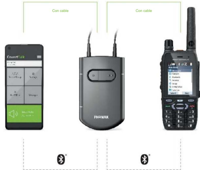
Roger™ Covert C puede manejar un enlace Bluetooth® mientras que Roger Covert Dual C separable puede manejar simultáneamente un enlace Bluetooth® y un enlace cableado separable.
