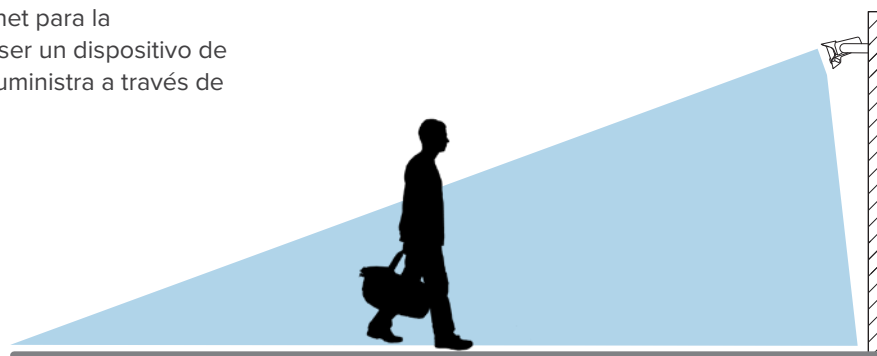
Senstar MultiSensor se instala inclinado hacia abajo en un ángulo aproximado de 20°, de 2.4 a 3.7 m por encima del suelo.
