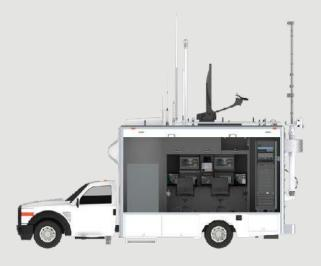
Centro de comando y control móvil instalado en un vehículo pesado.
