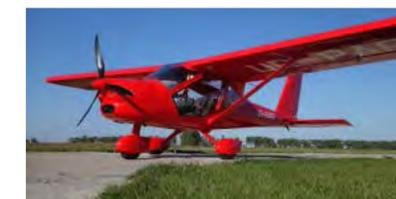
Un aerodinámica 'state-of-the-art', perfectamente 'limpia'. A primera vista es fácil ver la calidad de los acabados: tren y ruedas con carenado, al igual que las riostras. El fuselaje y la parte delantera donde se ubica el motor elimina todo tipo de elementos que
