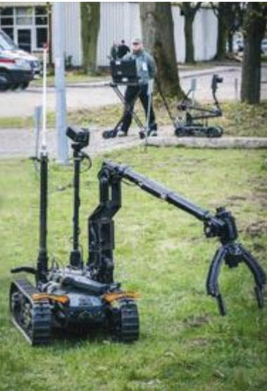
La plataforma del robot está equipada con cuatro asas de transporte para asegurar el robot. Un innovador sistema de cámaras de vista lateral complementa las cámaras de unidad estándar y amplía enormemente el campo de visión del espacio que rodea al robot y, por lo tanto , facilita la maniobra en espacios reducidos.
