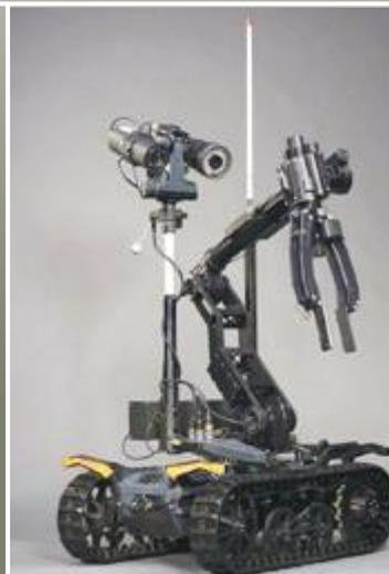
HBA RMI tiene un diseño compacto y modular que permite su transporte , por ejemplo . en el maletero de un coche . El manipulador de cinco grados de libertad con pinza garantiza un alcance de más de 2 m y un amplio rango de movimiento en cada plano. Cuando se pliega a la posición de transporte , el robot es compacto y compacto . Su manipulador puede transportar cargas de hasta 25 kg.
